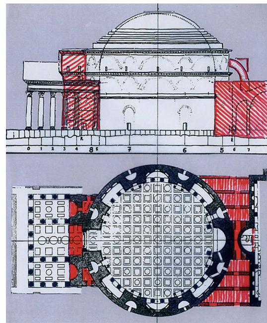
Abb. 6: Pantheon II: Ausgeführtes Projekt mit Abstützungsmaßnahmen Nord und Süd.
