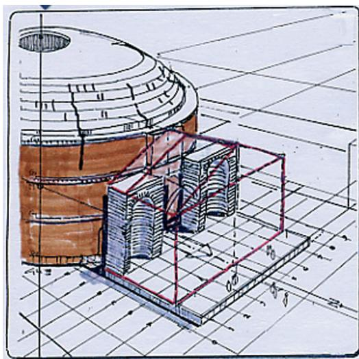
Abb. 9: Im Innern der Rotunde beginnt man mit der Ausschalung der Kuppel (Kassetten) von oben nach unten. Parallel dazu erfolgen Nachbesserungsarbeiten. Abtransport der Schalungskörper. Das Montagegerüst wird parallel zur Ausschalung ebenfalls abgebaut.
