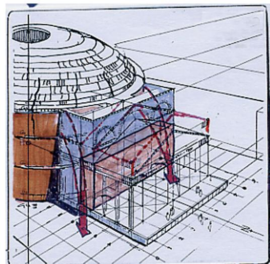
Abb. 10: Es wird beschlossen, Kuppel und Rotunde mittels zweier Anbauten abzustützen: dem Zwischenbau Nord und dem Zwischenbau Süd. Wir wissen heute, dass die nachfolgend dargestellten Maßnahmen (sog. «Bookends», Verf.) sinnlos waren, denn die Kuppel hätte ohne sie bestanden und wäre nicht eingestürzt. Einbau der Treppenhäuser Ost und West — Aufbau des Festpunktes bis auf volle Höhe Gesims G 3, als Auflast zur besseren Ableitung der Schubkräfte.
